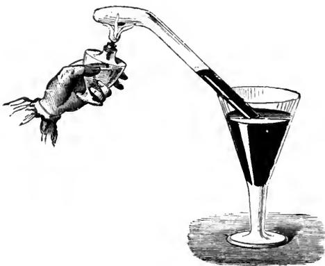
FIG. 28. — Action du potassium sur l'acétylène.
